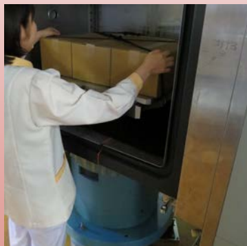
(左より、突き刺し強度試験、振動試験、落下試験)
